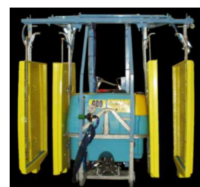
S21 - Panneaux récupérateurs
