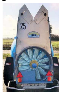
S21 - Double turbine vergers voûte droite
