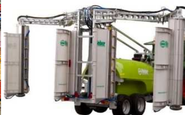
WEBER – descentes avec panneaux récupérateurs
