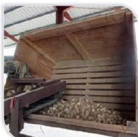
Inclinaison du palox lors du remplissage
