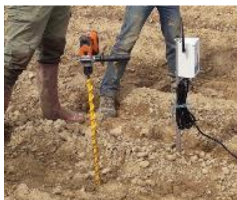
Sondes tensiométriques connectées, sonde capacitive connectée, humidité du sol sur 25 cm à l'aide d'une gouge – Photos CA31
