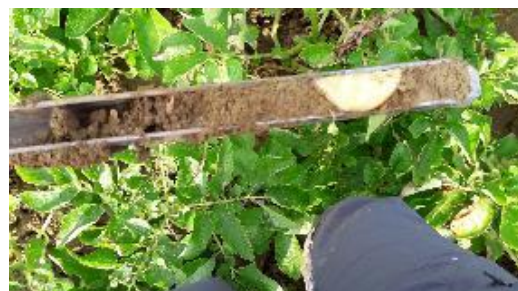
Sondes tensiométriques connectées, sonde capacitive connectée, humidité du sol sur 25 cm à l'aide d'une gouge – Photos CA31
