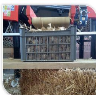
Surélévation des caisses en sortie de chaîne de calibrage
