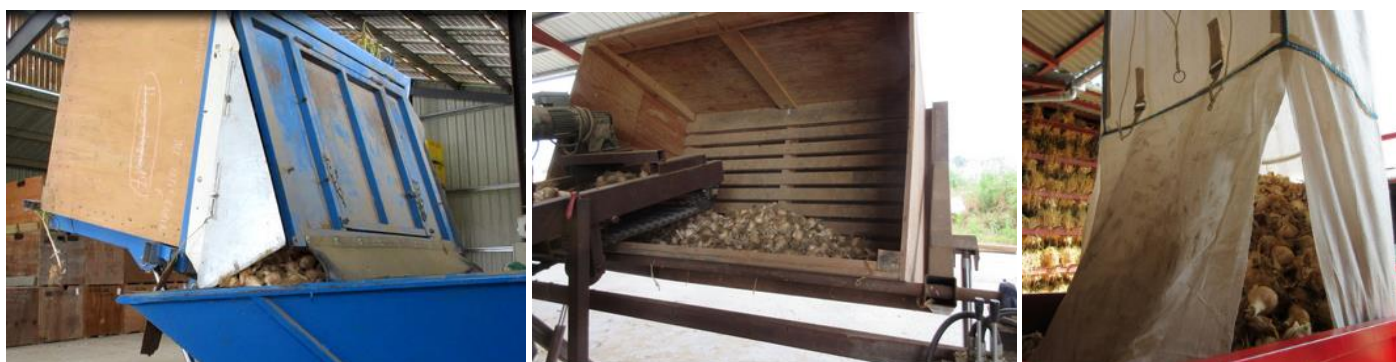
Toutes les précautions doivent être mises en œuvre pour limiter les hauteurs de chute et les chocs – Photos CA81
