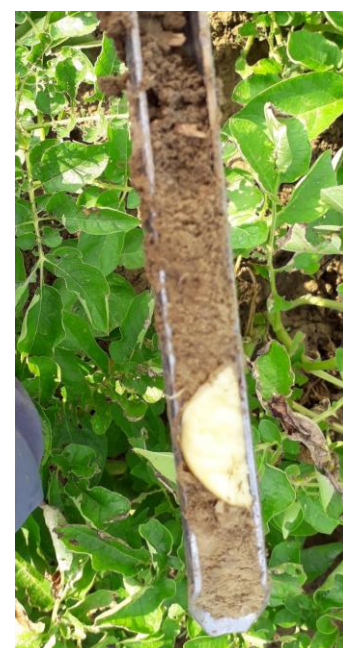
Contrôle du niveau d'humidité à l'aide d'une gouge – Photo CA31
