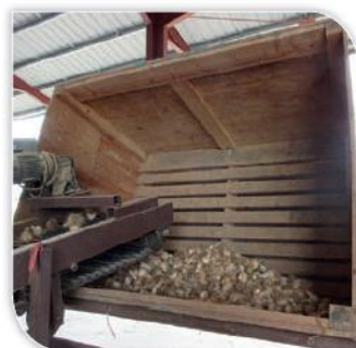
Inclinaison du palox lors du remplissage
