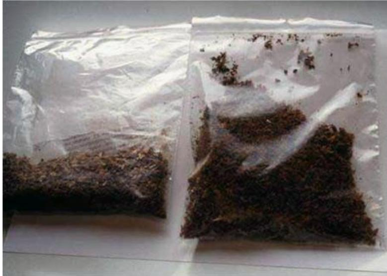
**Extraction de sciure de bois de conifères sensibles au nématode du pin à la perceuse sans fil, mèche diamètre 12 mm, pour analyse au laboratoire de nématologie.**
