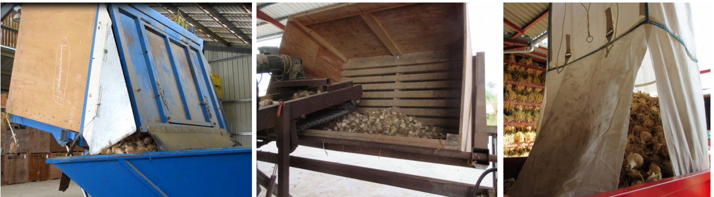
Toutes les précautions doivent être mises en œuvre pour limiter les hauteurs de chute et les chocs – Photos CA81
