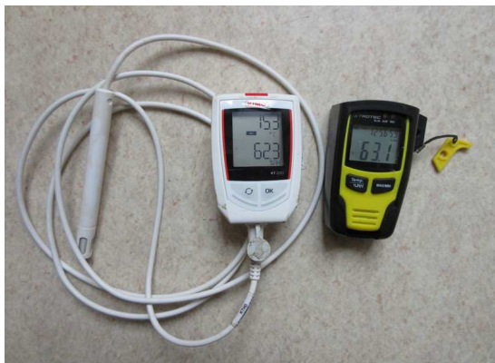
La pose de sondes de température et d'hygrométrie permet de suivre l'évolution des conditions de séchage - Photo CA81
