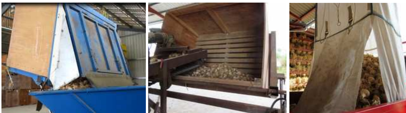
Toutes les précautions doivent être mises en œuvre pour limiter les hauteurs de chute et les chocs - Photos CA81
